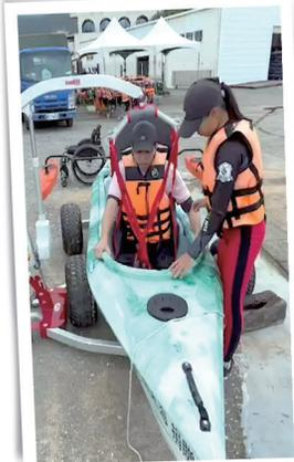
▲ 獨木舟船艙設置包覆型雙人座椅，兩側加裝輔助浮筒，岸上準備了移位機，讓身心障礙者可以輕易進入船艙。
